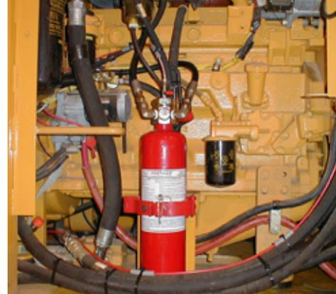
Aquí se puede ver el cilindro rojo de Firetrace, junto con el tubo de detección rojo que recorre las áreas críticas.
